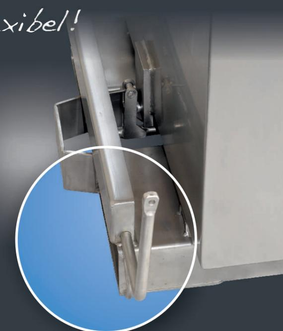
Neben der automatischen Entriegelung ermöglichen beidseitig angebrachte Handhebel ein manuelles Entriegeln. Diese können optional auch über ein Zugseil vom Fahrersitz aus betätigt werden.
