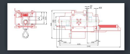
Luftanschluss max. 8 bar, bauseits
